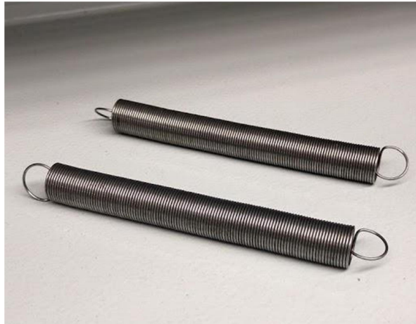
Figura 5-15: Molas de aço de comprimento 8mm e K \cong 28 \text{ N/m}
